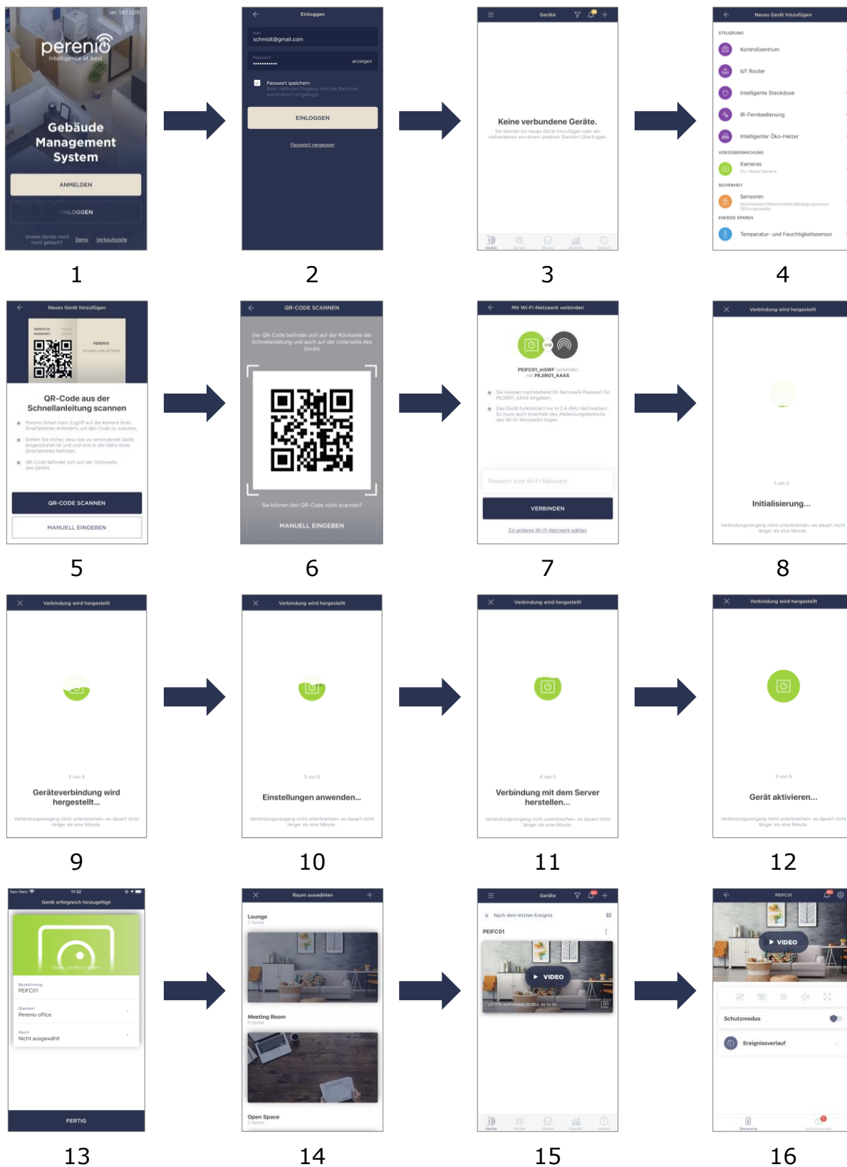
Bild 7 – Verfahren zum Hinzufügen eines neuen Geräts (Kamera-Aktivierung)
